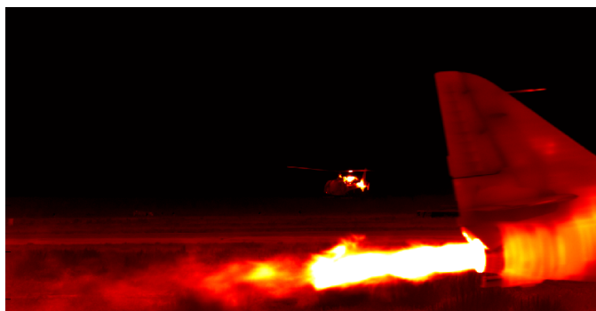
Mesure de la signature IR des moteurs à réaction
