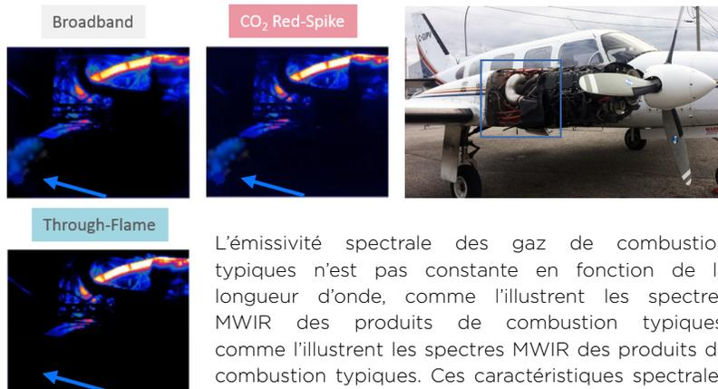
L'émissivité spectrale des gaz de combustion typiques n'est pas constante en fonction de la longueur d'onde, comme l'illustrent les spectres MWIR des produits de combustion typiques. Ces caractéristiques spectrales peuvent être observées en temps réel grâce à l'imagerie multispectrale à résolution temporelle. multispectrale résolue dans le temps.
